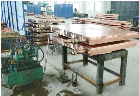
水压试验 HYDRAULIC PRESSURE TEST
